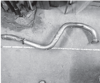
ごみピットに投入されたマフラー
