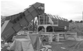
集められた不燃ごみはこの大型粗選別機（写真左）を通して、10%以下とそれ以上のごみに分別される。右上の写真は選別機内部。内部には10%の穴（写真右下）がたくさん開いていて、回転すると小さいごみは下に落ちる仕組みになっている。小さいごみはそのまま処分場へ、大きいごみは圧縮梱包機へ。家電などの大きなごみが入ると機械が故障します。絶対不燃ごみに入れないで！
