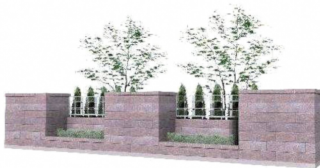
安全なブロック塀等への改修例
